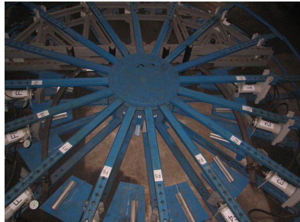
Stanowisko badań wytrzymałości konstrukcji (podpórności) odrzwi obudowy wyrobisk korytarzowych i komorowych
