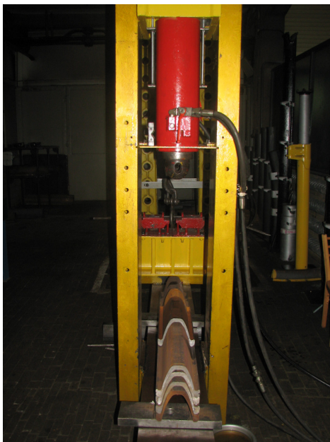
Prasa hydrauliczna do badań elementów obudów górniczych
